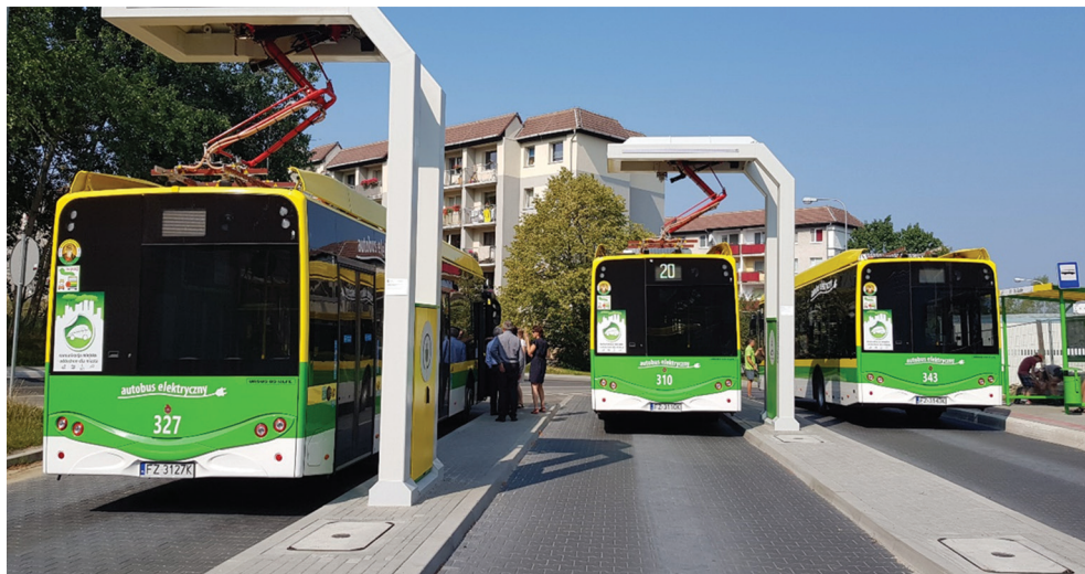
Rysunek 1. Ładowanie autobusów na terenie jednej z zajezdni
